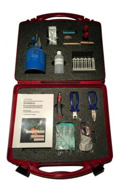
Mit dem Kunststoff-Erkennungs-Kit sollen Analysen innerhalb von maximal 12 min durchführbar sein.
