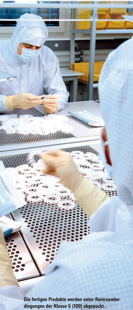
Die fertigen Produkte werden unter Reinraumbedingungen der Klasse 5 (100) abgepackt.
